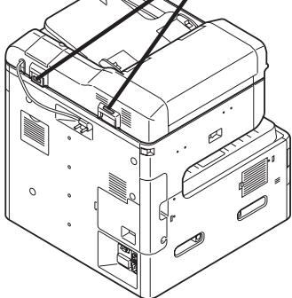
机器内部的标签 (激光辐射警告)
